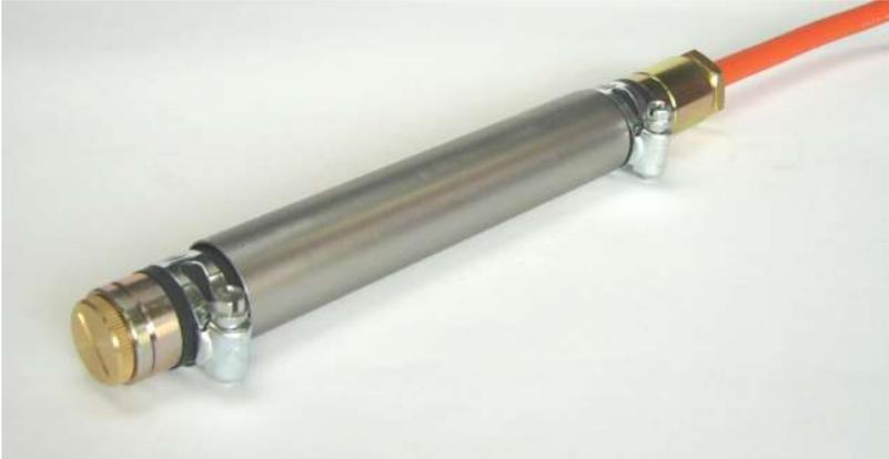
本計器は、土木建築工事での山留や基礎において、シートパイル、鉄管、鉄管矢板、H鋼、コンクリート壁、コンクリート杭等、設置して歪を測定することができます。
