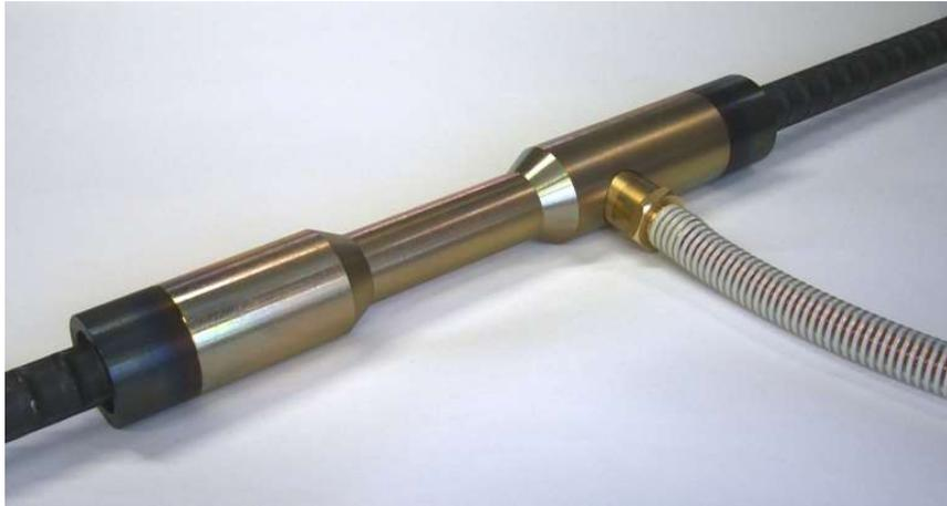
本器は、各種鉄筋コンクリート構造物に設置して歪を検出することにより応力を測定することができます。検出部には高精度な差動トランスを使用し、絶縁低下による影響も受けにくいいため、長期にわたり安定した測定ができます。
