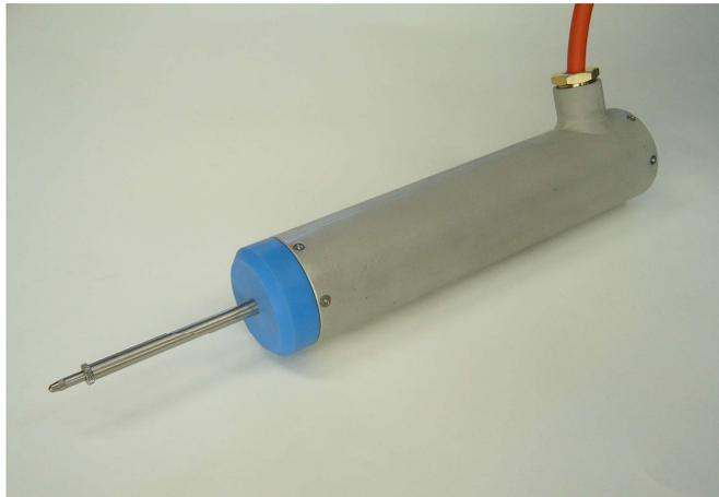
本器は、既存構造物等に設置して、設置箇所との2点間の直線変位を測定できます（杭の載荷試験や地盤、構造物の沈下量など）。またインバー線を併用することにより、離れた箇所の変位を測定することも可能です。検出部には高精度な差動トランスを使用し、絶縁低下による影響も受けにくいいため、長期にわたり安定した測定ができます。
