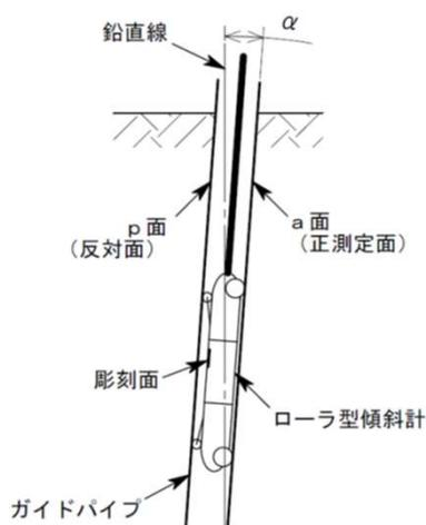
計測管は□75の角パイプを使用しますが、180°反転させて対向する2面を測定して鉛直からの傾斜角を算出する方法により、傾斜計の原点ドリフトがキャンセルされ、より高精度な計測が可能となります。
