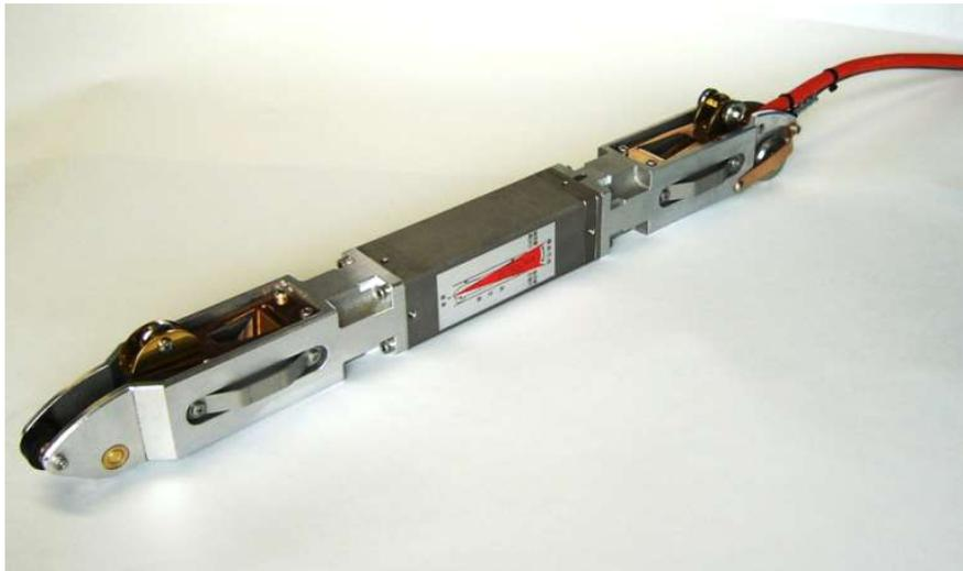
本器は、土木建築工事での山留や地盤の変形、隣接構造物の傾斜計測において、地中連続壁、シートパイル、鋼管矢板、H鋼、コンクリート壁等に計測管を設置し、深度ごとの傾斜を測定して区間ごとの水平変位を算出することができます。
